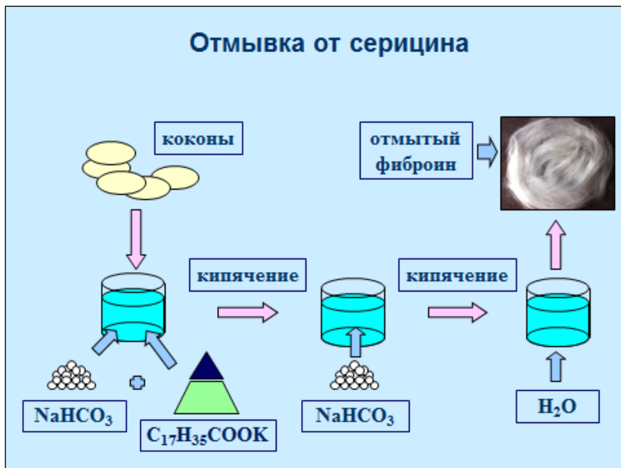
Рисунок 2 — Схема отмывки шелка от серицина и сопутствующих компонентов.
